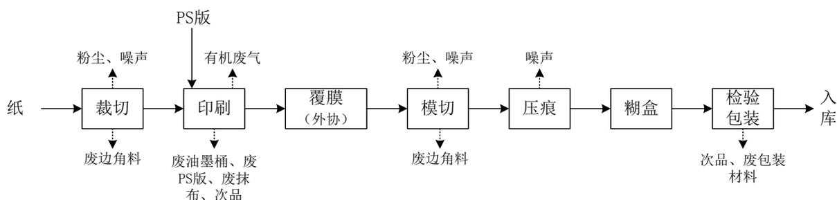
图 5-1 本项目印刷品的生产工艺流程及产污图
